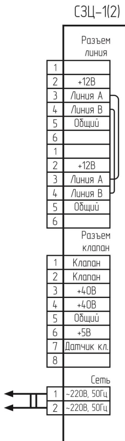
Рисунок Б.1 электрическая схема сигнализатора СЗЦ-1(2).
